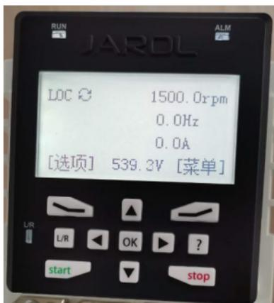
图 4-1 操作面板示意图
